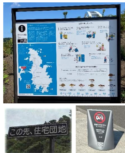
出島観光誘導標識 上：マナー標識（釣りのマナーや車両通行推奨ルートなどを掲載） 下左：誘導標識（運転者への注意喚起として設置） 下右：駐車規制標識（必要に応じて規制場所を変えられるよう人力で移動可能な仕様）
