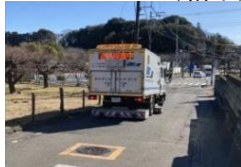
(空洞探査車による調査)
