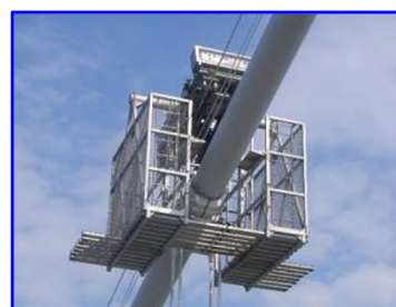
ケーブル作業車 ※ (2台/橋) ケーブル下面も効率的に点検
