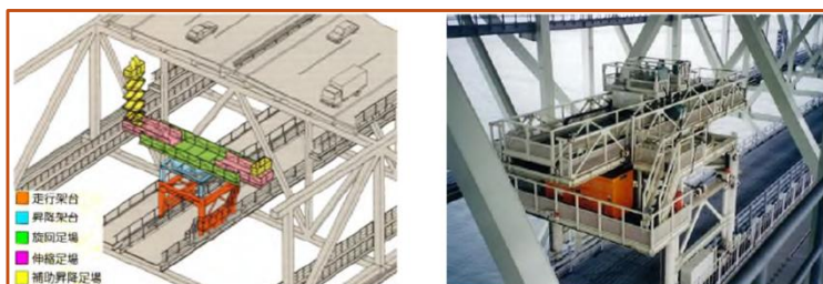
桁内面作業車(1台/橋)
