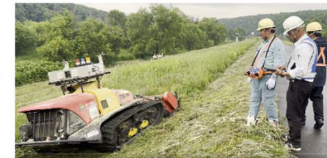
安全監視員の下、自動運転を行う様子
