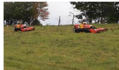
令和7年度試行工事における堤防除草自動化
