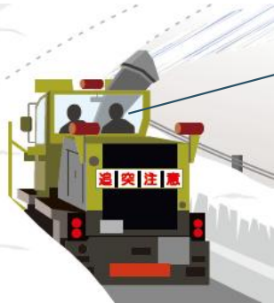
ロータリ除雪車による車道除雪(2名体制)
