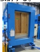
止水性検証試験機 (処分済)
