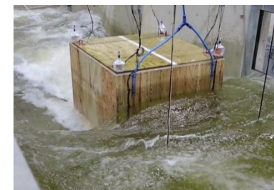
▲ 縮小模型による水理実験の様子
