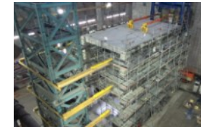
RC造実大架構を対象 とした構造実験
