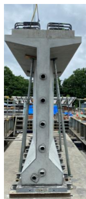
桁高2.6mの実大PC部材
