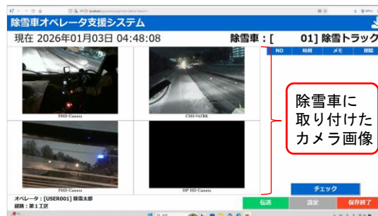
図-2 実作業中の除雪車での評価試験状況(支援者 PC の画面例)
