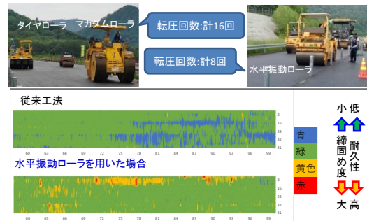
図-6 試験舗装の面的な締固め度測定結果 (縦:幅員方向・横:延長方向)
