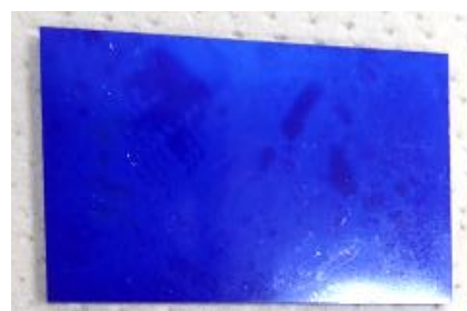
図-2 現行基準で耐有機酸性を有するとされた樹脂の酢酸ガス暴露試験後の状況（40℃1か月）
