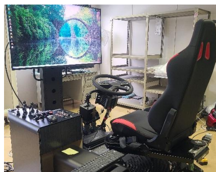
図-3 除雪トラック技能訓練シミュレータ用の模擬運転室
