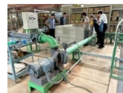
図4 逃し弁の室内実験検討の様子 (農研機構農村工学研究部門の実験室にて。同部門との共同研究を計画)
