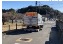
（空洞探査車による調査）
