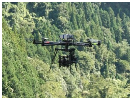
ドローンによる画像計測
