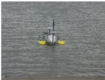
無人ボートによる堆砂測量
