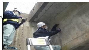
AEセンサを利用した PCグラウト充填把握
