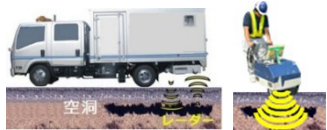
路面下空洞調査
