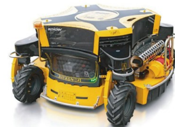
遠隔操縦式草刈機による除草
