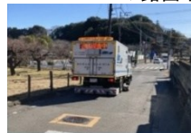
(空洞探査車による調査)
