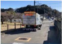
(空洞探査車による調査)
