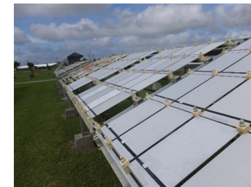
技術開発 塗料の暴露試験状況(宮古島)
