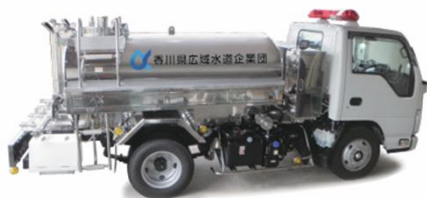
▲令和2年度 東讃ブロック統括センターに配備した加圧式給水車
