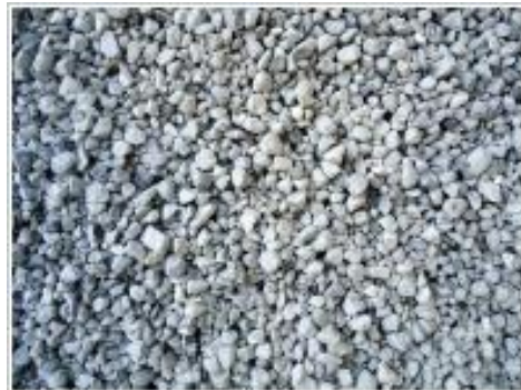
再生コンクリート骨材
