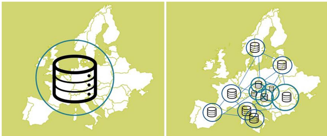
図 3-1 中央集中型（左）と分散型（右）のアーキテクチャ（再掲）
