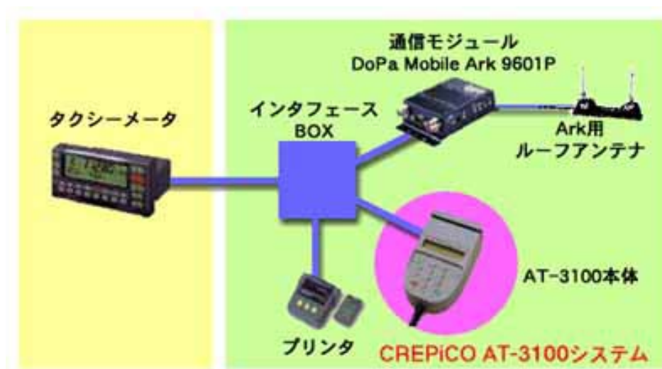
図 1.14 タクシー用カード決済システムの標準的な構成
