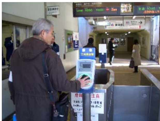
図6 簡易型 I C カード改札機で乗車処理（入場）を行う様子
