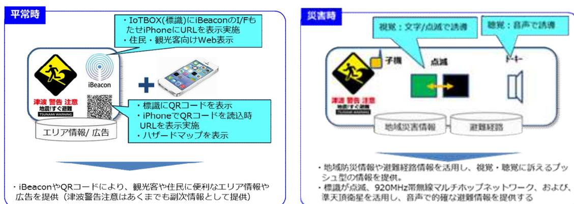
図3 プッシュ型情報提供装置の概要
