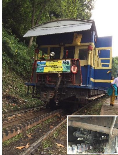
写真7 最後尾。アプト式のラックレールと客車にも歯車が見える。(右下拡大)
