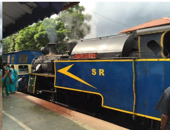
写真10 スイス製のアプト式機関車「ニルギリクイーン」。下り坂方向では列車の先頭で後ろ向きに走る。
