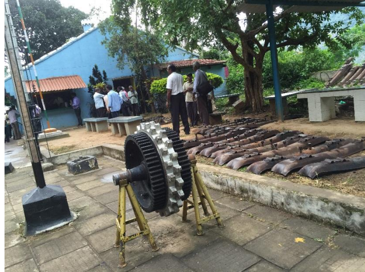
写真8 NMRで使用しているアプト式のピニオン(歯車)の展示。2枚の歯車の位相をずらして貼り合わせた特徴的な形がよく分かる。
