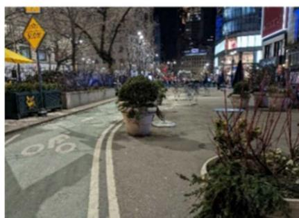
写真 1 法的拘束力のある白色の道路標識に代わって、シェアードストリートに設置された低速運転を推奨する黄色道路標識(2023 年 2 月国土交通政策研究所撮影)
