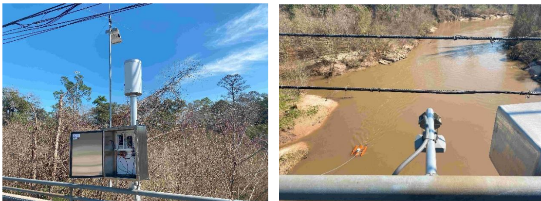
写真7（左）バイユーの橋上の観測機器（右）レーダによる水位計測（筆者撮影）
