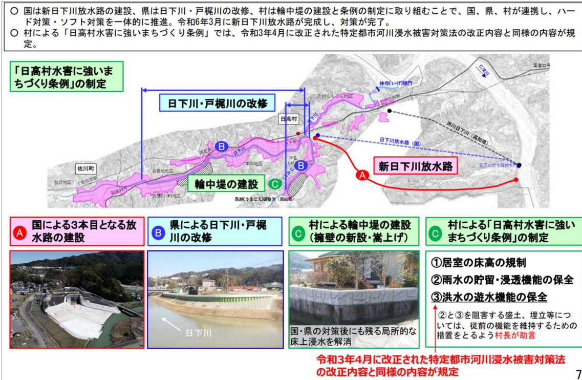
図 18 国・県・村の連携による日下川の総合内水対策の概要 59
