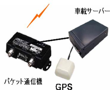
図 2 プローブ車載器
