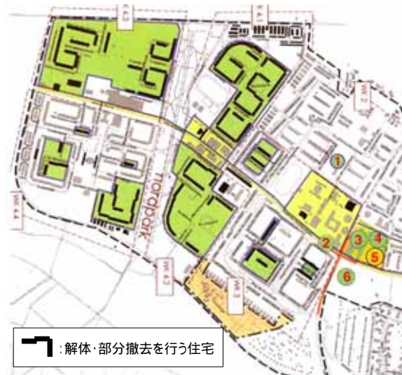
図 - 6 公営住宅の解体・部分撤去計画 19 （2002年策定 ヴォルフエン 北部地区）
