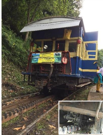
写真7 最後尾。アプト式のラックレールと客車にも歯車が見える。(右下拡大)
