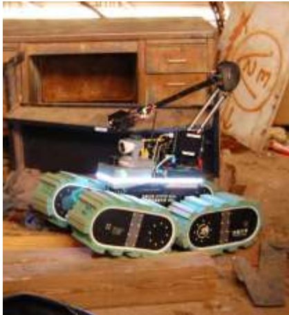
体育館の天井崩落調査 Kohga3, 松野(京大)
