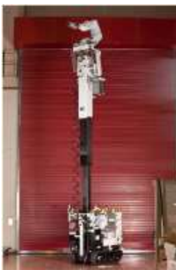
高所調査用ロボット
