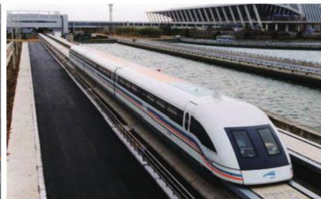
上海トランスラピッド。浦東国際空港と上海市郊外を結ぶ磁気浮上式鉄道。最高速度 430km/h。
