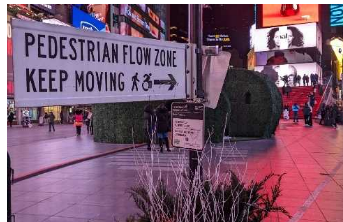
写真18 歩行者の滞留空間と歩行空間を分ける歩行者流動区域の標識（白線より右側が歩行空間）
