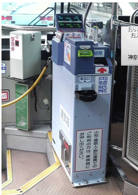
整理券にバーコードを印字し、運賃箱は運賃表示器と連動しており、投入されたバーコード付き整理券を読み取って運賃額を表示、さらに投入された硬貨をカウント（自動計数）する。
