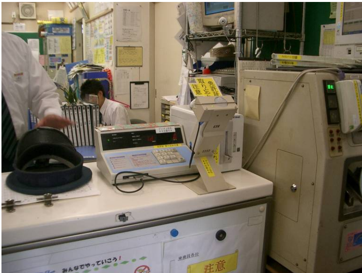
写真 2 点呼場所 アルコール検知器 免許証期限確認装置
