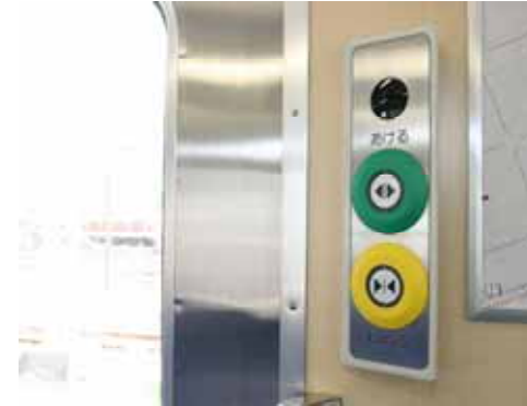
写真 - 2 ドア開閉ボタン
