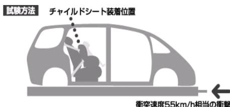
なお、衝突速度は、国の安全基準（道路運送車両の保安基準）における試験の1割増しの55km/hで実施します。また、試験実施に用いる座席シートは、国の安全基準における試験では、試験用の座席シートを用いるのに対し、実際の自動車の座席シートを用います。
