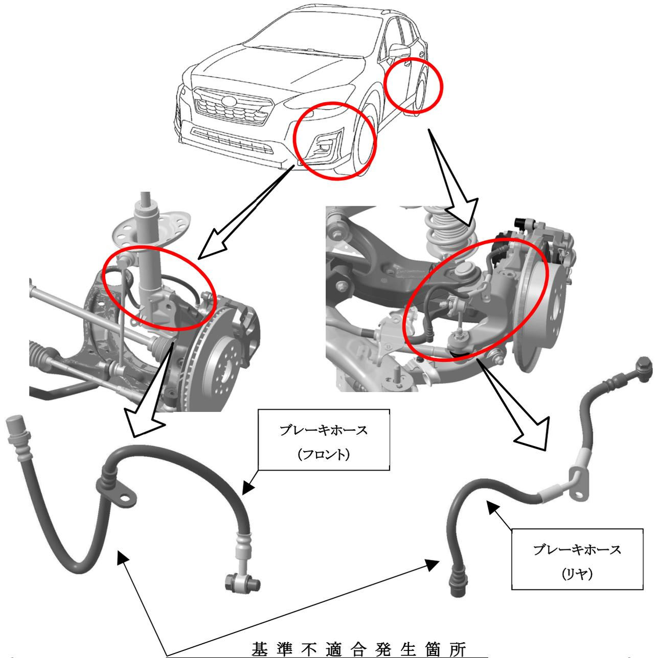
ブレーキホースにおいて、ブレーキ圧に対する耐久性評価が不十分なため、ホース接続金具加締め部のシール性が不足しているものがある。そのため、ブレーキフルードがホース外層と内層の間に浸潤し、ブレーキホースが膨らむおそれがある。
