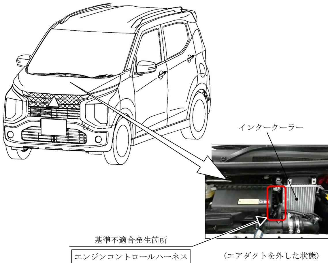
過給機付きエンジン車のエンジンコントロールハーネスにおいて、配索が不適切なため、走行時の振動で当該ハーネスがインタークーラーのケースと接触することがある。そのため、当該ハーネス内の電線の被覆が削られて短絡し、最悪の場合、走行中にエンジンが停止するおそれがある。
