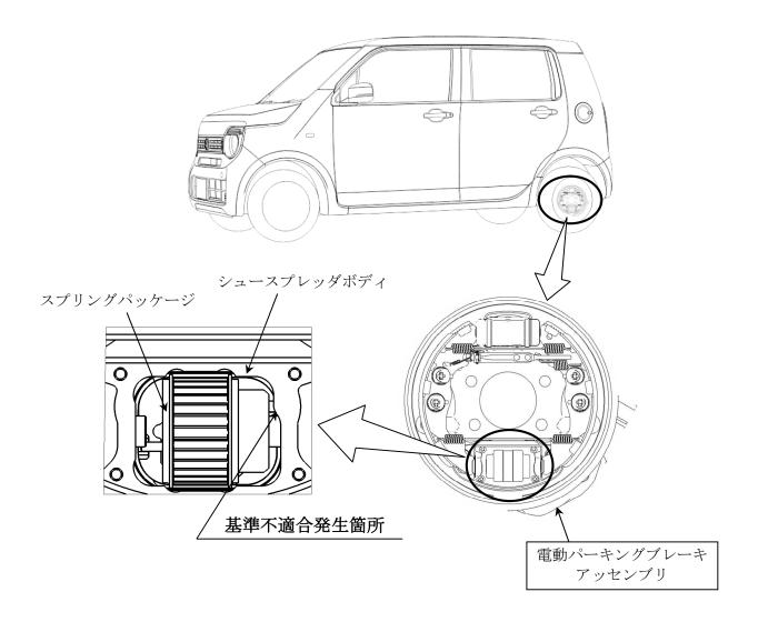
電動パーキングブレーキにおいて、ドラムブレーキシューの拡張、収縮を行うためのスプリングパッケージの作動ストローク設定が不適切なため、パーキングブレーキ解除時に当該スプリングパッケージがシュースプレッダボディに干渉し、モータ負荷が高くなることがある。そのため、モータの電流値が閾値を超えてVSAが異常を検知し、警告灯、警告表示が点灯して駐車ブレーキが作動しなくなるおそれがある。
