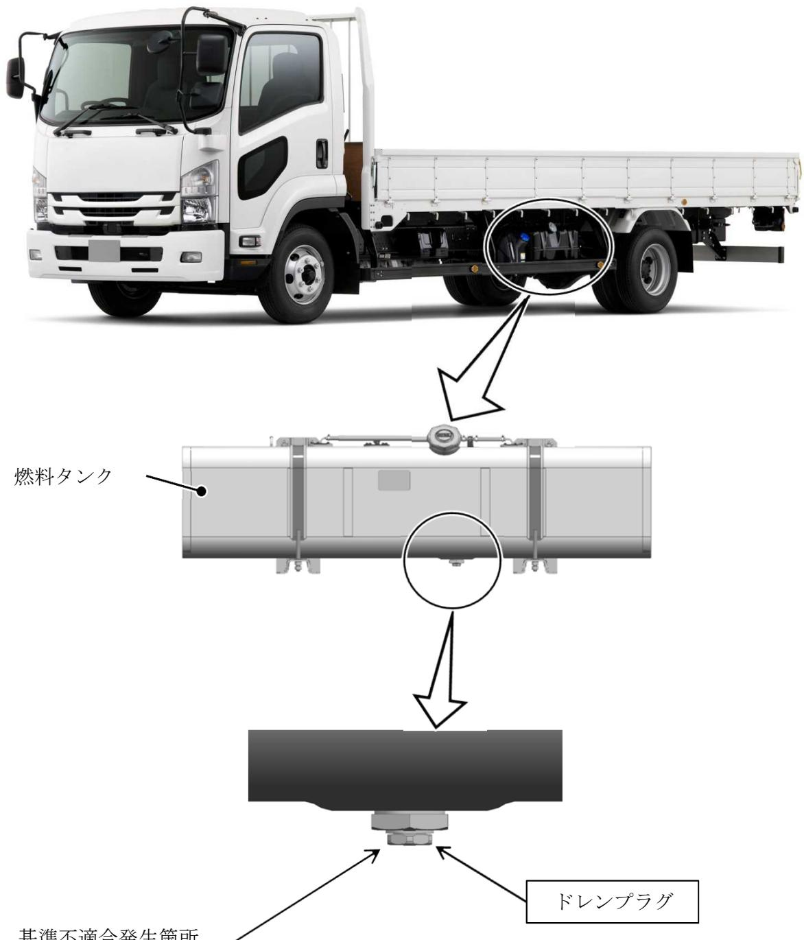
中型トラックの燃料タンクにおいて、ドレンプラグの燃料タンクへの組み付け作業が不適切なため、ドレンプラグが適切に締め付けられていないものがある。そのため、そのままの状態で使用を続けると、ドレンプラグ部より燃料が漏れるおそれがある。
