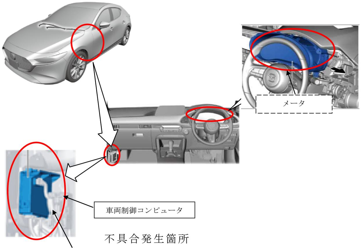
車両制御コンピュータにおいて、スマート・ブレーキ・サポート（SBS）の制御プログラムが不適切なため、S字路の路肩に停車した車両や大きな道路標識などを正しく認識できないことがある。そのため、衝突の可能性がないにもかかわらず障害物との接近を知らせる警報音が鳴り、ディスプレイに警告表示が出て、最悪の場合、衝突被害軽減ブレーキが作動し、急制動がかかるおそれがある。
