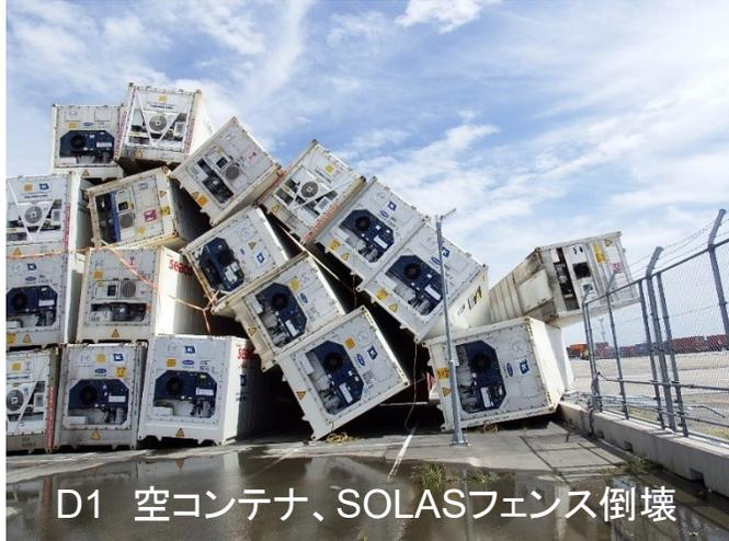
D1 空コンテナ、SOLASフェンス倒壊
