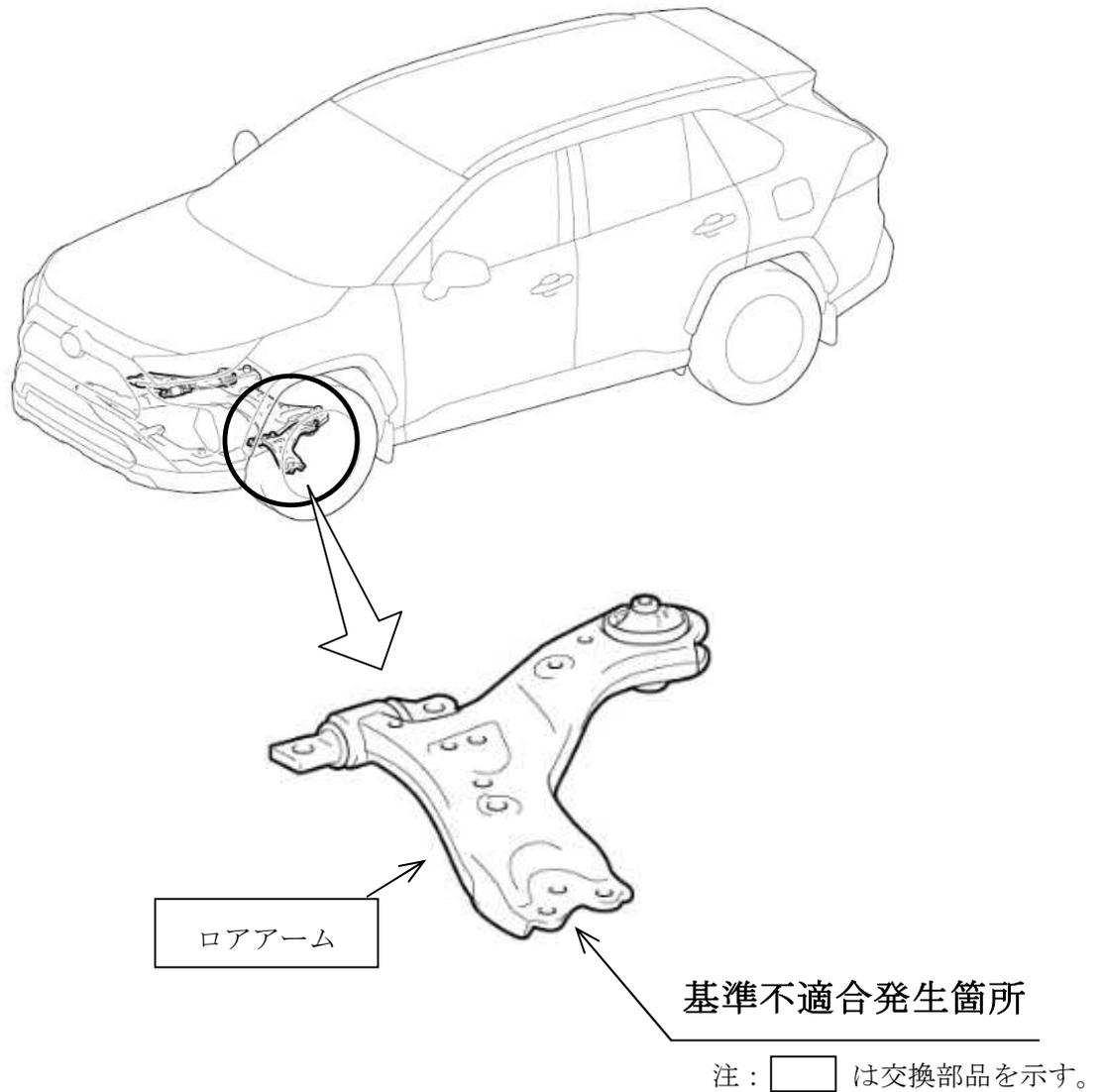
前輪緩衝装置において、材料製造工程が不適切なため、ロアアームに亀裂が入っているものがある。そのため、そのまま使用を続けると亀裂が進展し、最悪の場合、ロアアームが破断して、走行安定性を損なうおそれがある。
