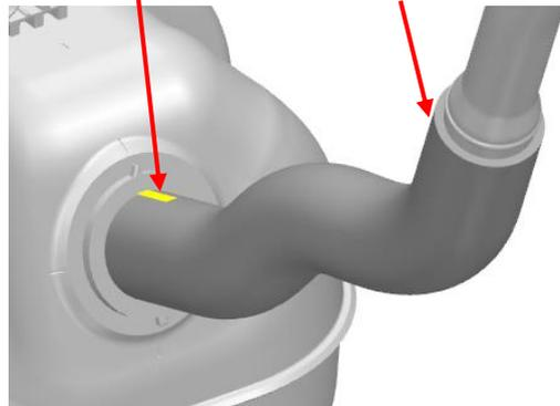
燃料フィルターホースにおいて、組み付け方向が誤っているため、当該ホースが変形しているものがある。そのため、そのまま使用を続けると、当該ホースに亀裂が発生し、最悪の場合、燃料が漏れるおそれがある。
