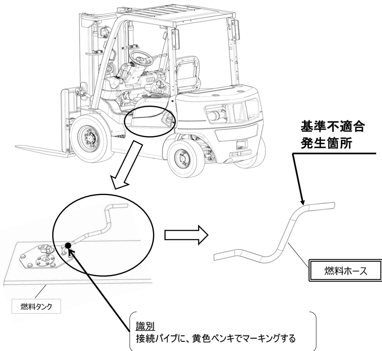
ガソリンを燃料とするフォークリフトにおいて、燃料ホースの材質の選定が不適切なため、亀裂が生じるものがある。そのため、亀裂が進行すると燃料が漏れるおそれがある。
