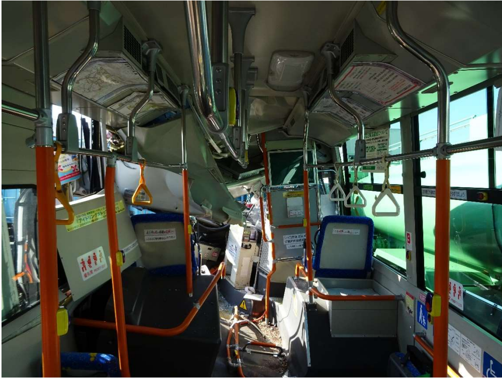
写真6 当該車両の損傷状況（車内）
