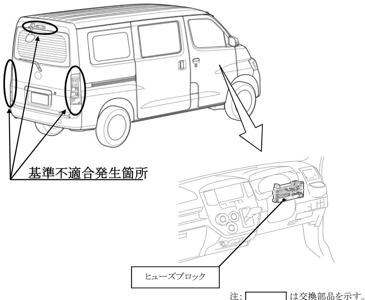
寒冷地仕様車のヒューズブロック内にあるボデー統合制御コンピュータにおいて、制動灯を制御する回路の設計が不適切なため、ワイパー作動時のノイズによってヒューズブロックに過電流が流れて内部素子が破損するものがある。そのため、そのままの状態で使用を続けると、最悪の場合、制動灯が点灯しなくなるおそれがある。
