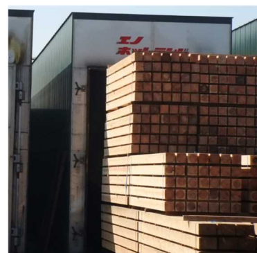
写真-9 蒸気式乾燥
