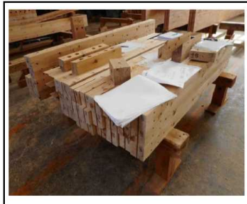
写真-5 モックアップ材の材料検査の例
