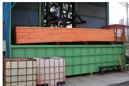
写真-6 浸漬槽 (全面浸漬用)の例
