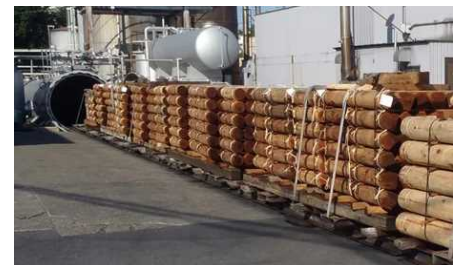
写真-3 加圧注入前木材の例
