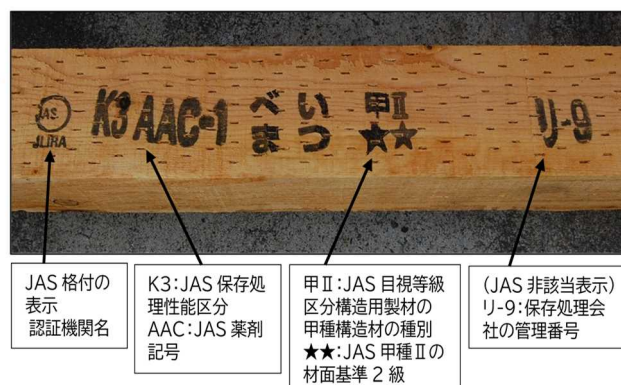
写真-1 JAS 規格材の表示、保存処理性能 K3 表示
