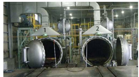
写真-2 加圧注薬缶の例
