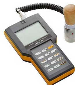
写真-6 電気抵抗式水分計の例
