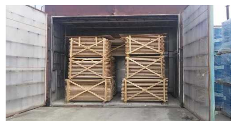
写真-5 保存処理後乾燥室の例
