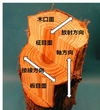
図-2 木材の3断面・3方向
