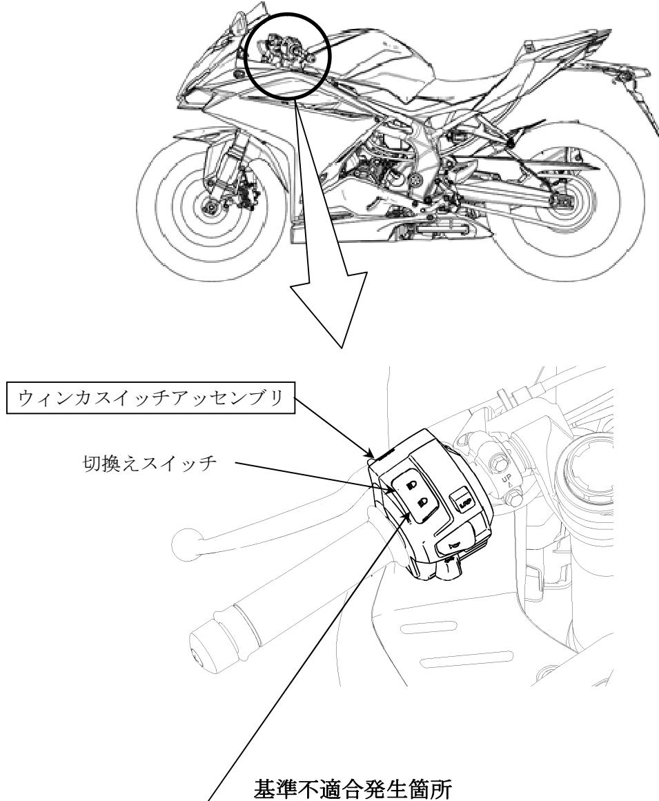
灯火装置において、走行用前照灯とそれ違い用前照灯切換えスイッチの接点構造が不適切なため、はんだフラックスが接点表面に残留するものがある。そのため、そのまま使用を続けると、切換えスイッチが接触不良となり、最悪の場合、走行用前照灯が不灯となるおそれがある。
