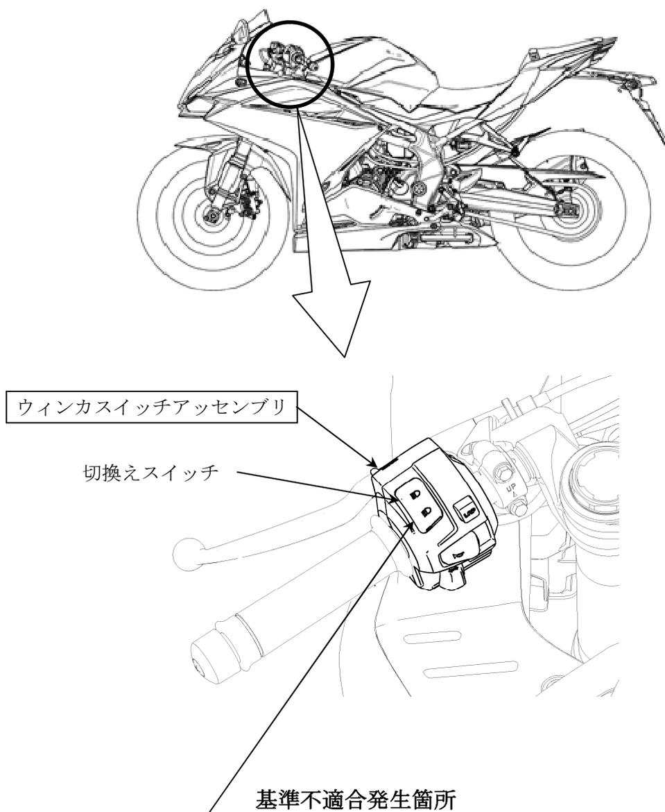
灯火装置において、走行用前照灯とすれ違い用前照灯切換えスイッチの接点構造が不適切なため、はんだフラックスが接点表面に残留するものがある。そのため、そのまま使用を続けると、切換えスイッチが接触不良となり、最悪の場合、走行用前照灯が不灯となるおそれがある。
