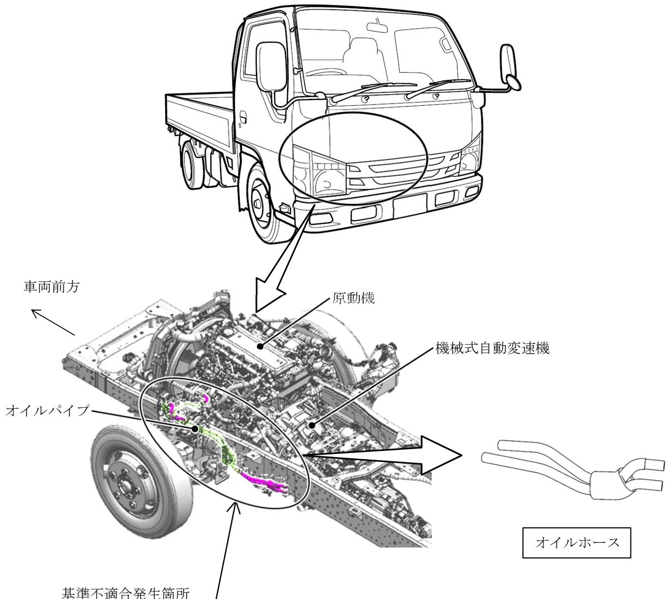
小型トラックの機械式自動変速機において、オイルホース製造工程での作業が不適切なため、ホースのシール性が低下しているものがある。そのため、当該ホースとオイルパイプの継ぎ目からオイルが漏れて変速不良となり、最悪の場合、走行不能に至るおそれがある。
