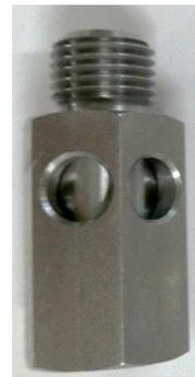
エンジンの油圧を調整するリリースバルブにおいて、組立作業が不適切なため、リリースバルブの構成部品が脱落し、エンジンの油圧が低下する場合があります。そのため、油圧警告灯が点灯するとともにエンジンが潤滑不良となり、最悪の場合、エンジンが停止するおそれがある。
