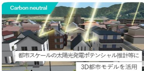
石川県加賀市において、加賀市と連携し、建物の屋根面積、傾き、隣接建物による日陰発生など、3D 都市モデルのデータを活かした都市スケールの太陽光発電ポテンシャル推計等のシミュレータを開発。
