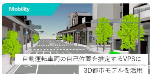
静岡県沼津市において、静岡県と連携し、カメラ画像から取得した情報と、3D 都市モデルの特徴点とを照らし合わせることにより、車両の自己位置を推定する VPS (Visual Positioning System) を開発。
