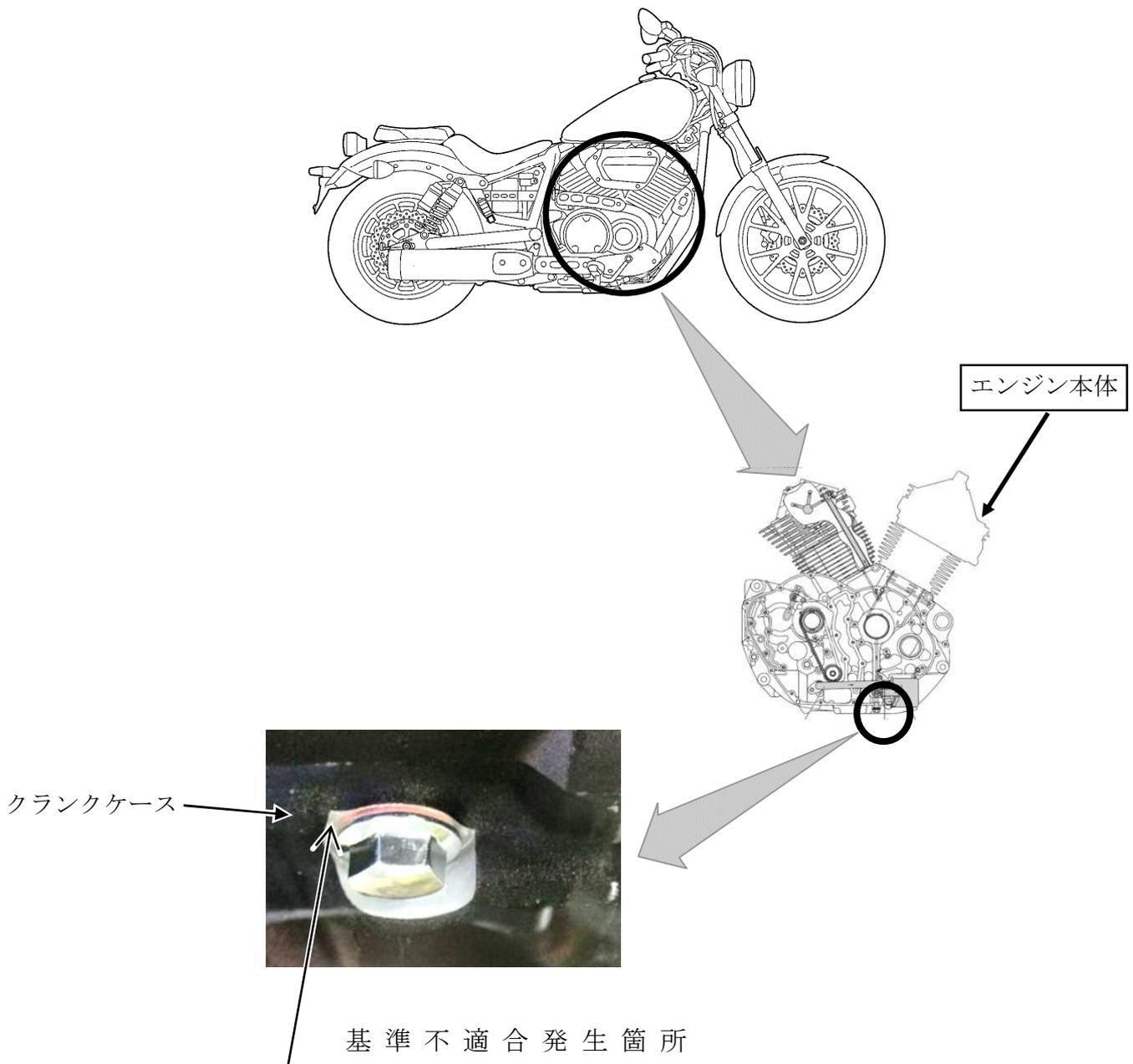
原動機のクランクケースにおいて、鑄造作業が不適切なため、エンジンオイルの通路と繋がる鑄巣穴が生じているものがある。そのため、運転時に当該鑄巣穴からエンジンオイルが漏れるおそれがある。
