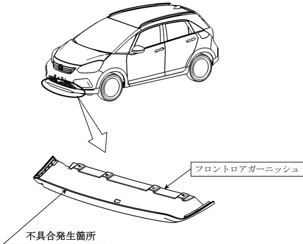
後付け用品として販売したフロントロアガーニッシュにおいて、フロントバンパへの固定構造が不適切なため、当該ガーニッシュの固定テープが剥がれるものがある。そのため、走行中の風圧によりガーニッシュが浮き、最悪の場合、ガーニッシュが脱落し、他の交通の妨げとなるおそれがある。
